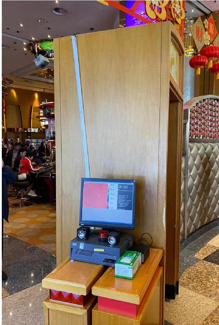
Equipamento de medição da temperatura corporal, instalado nas entradas dos casinos.
